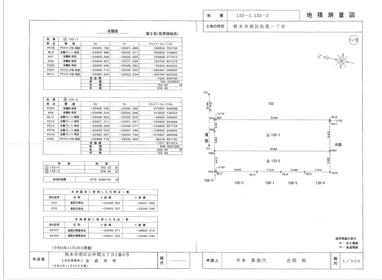
地 積 測 量 図 番 133-1, 133-2 土地の所在 熊本市西区松尾一丁目 2/2 恒久的地物 恒久的地物 符号 C12 符号 C13 名称 登記引照点 名称 登記引照点 世界測地系 測地系 測地系 世界測地系 X座標 -23398.462 -23403.207 X座標 成果 成果 Y座標 -33021.690 Y座標 -33044.548 標高 標高 備考 道路側溝縁に金属鋲 備考 道路側溝縁に金属鋲 概略図 概略 図 地物の状況 地物の状況 標識の状況 標識の状況 (令和5年11月29日測量) 熊本市南区出仲間五丁目2番8号 縮尺 縮 作成者 申請人 寺本 貴美代 吉岡 裕 土地家屋調査士 金 森 照 明 尺
